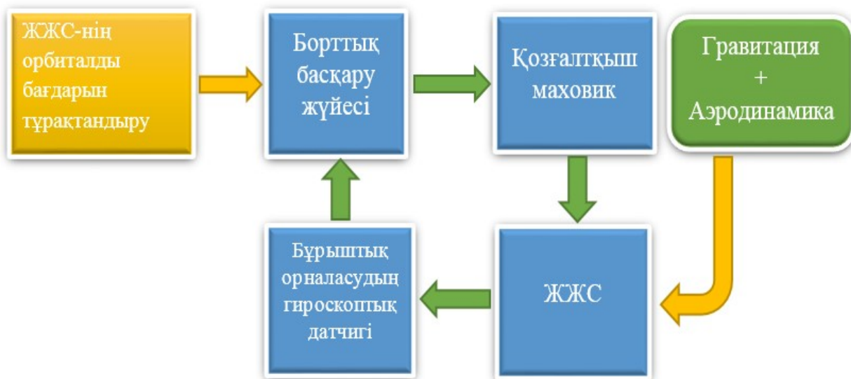
1.4 – сурет. Серіктің орбиталды бағдарын тұрақтандырудың блок сызбасы
